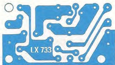
Fig. 2 Disegno a grandezza naturale del circuito stampato.
