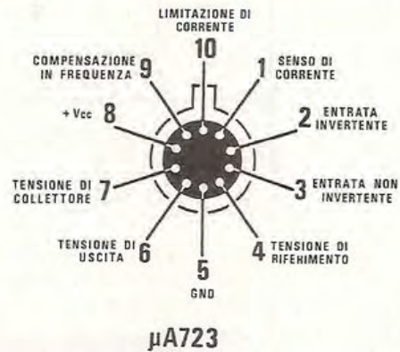
Fig. 5 Connessioni viste dal basso dell'integrato metallico uA.723, equivalente al SFC.2723. Questi dieci piedini vanno suddivisi in due file parallele da cinque, tenendo sulla destra i piedini 1 - 2 - 3 - 4 - 5 e sulla sinistra i piedini 6 - 7 - 8 - 9 - 10, in modo da poterli inserire nel circuito stampato, (vedi fig. 3)
